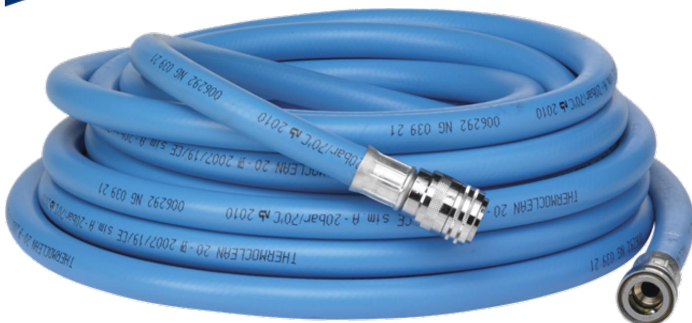
Pour le nettoyage à eau chaude, 70° C au maximum. Tuyau alimentaire opérationnel 1/2", muni d'un raccord 1/2" aux deux extrémités du tuyau. Avec raccord pour robinet fileté pour les types de filetage 1/2", 3/4" et M22x1.
