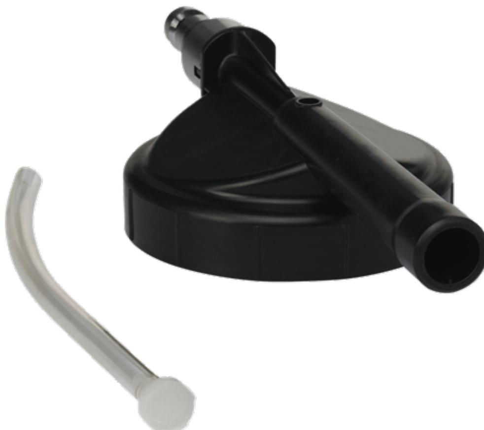
Injecteur à mousse pour nettoyage à mousse. Mélanger toujours l'eau et le produit chimique en proportion correcte: 0,40 - 10% et appliquer la mousse sur les surfaces. Utilisable pour les grands et les petits bidons. Avec tuyau d'aspiration et filtre.
