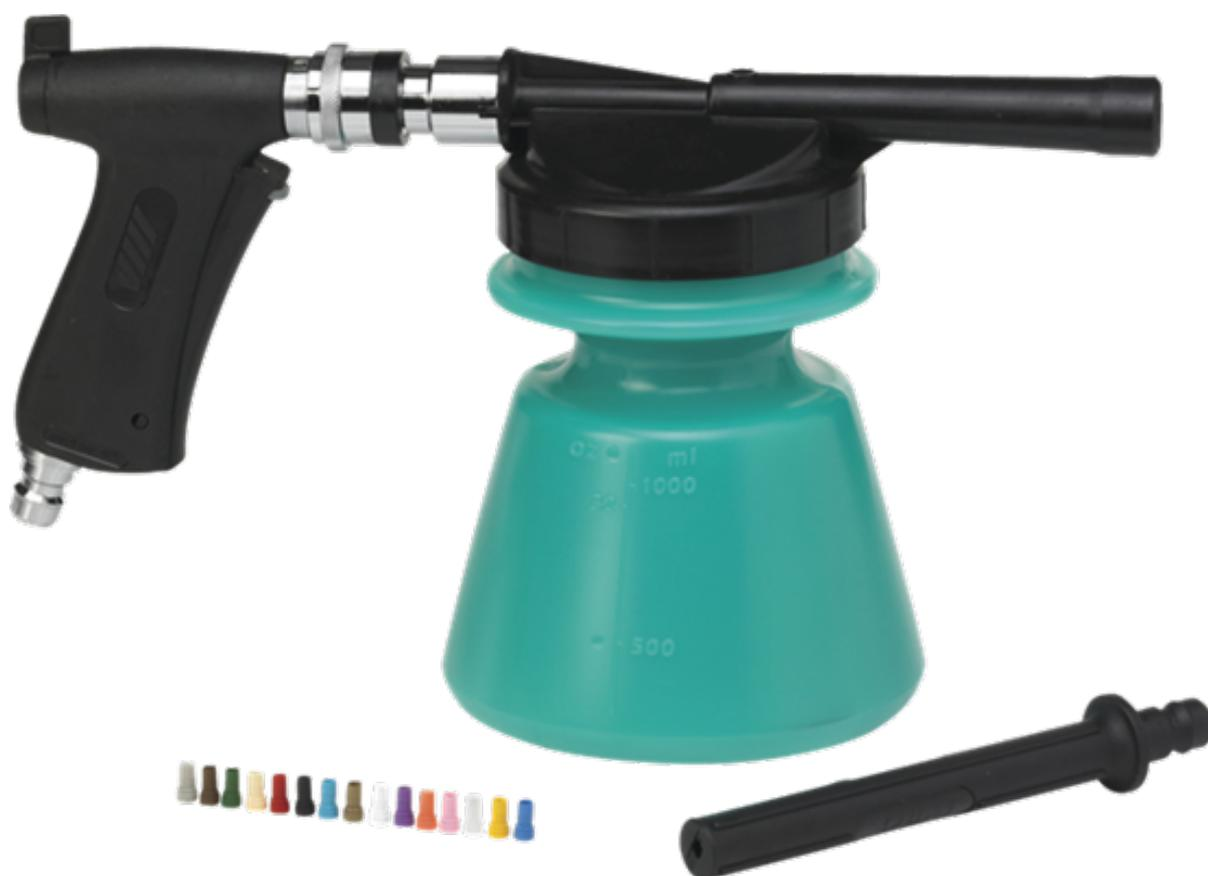
Pour le nettoyage des petites zones et des sanitaires notamment. Le pulvérisateur à mousse projete la mousse par pression hydraulique, sans aérosols. Mélanger toujours l'eau et le produit chimique en proportion correcte: 0,4 - 10%. L'identification chimique est assurée par le codage couleur.
